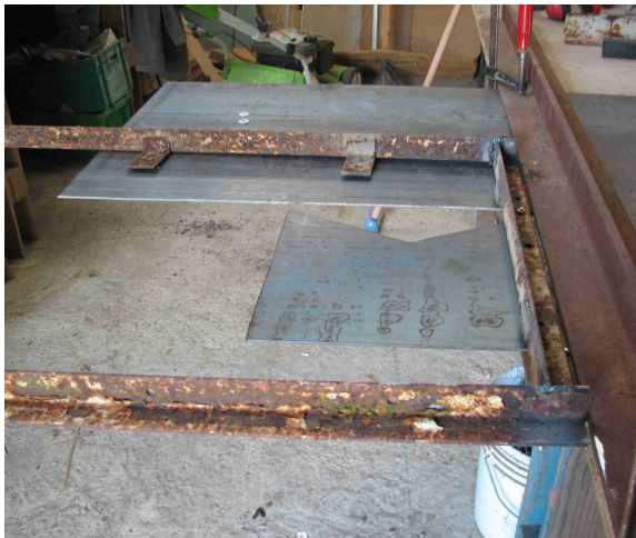
Découpe et pliage manuel de la tôle
