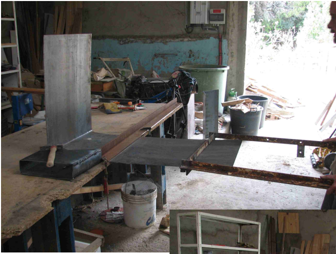
La plieuse auto-construite
