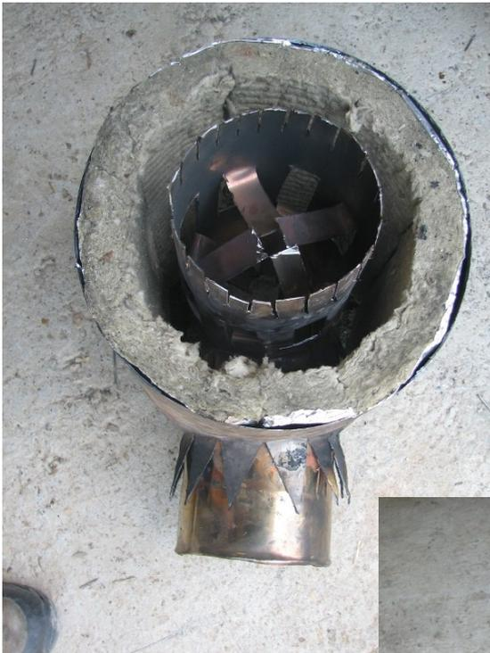
Montage des trois parties réalisées. A l'extérieur le bidon d'huile, à l'intérieur le tube inox avec ses languettes et son ouverture latérale et enfin le petit tube inox placé verticalement de l'un à l'autre.
