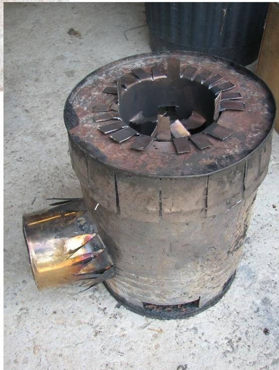
La partie haute du bidon d'huile est fendue pour être emboîtée sur la partie basse. On voit en bas les ouvertures permettant à l'air secondaire dans rentrer dans la chambre de préchauffage.
