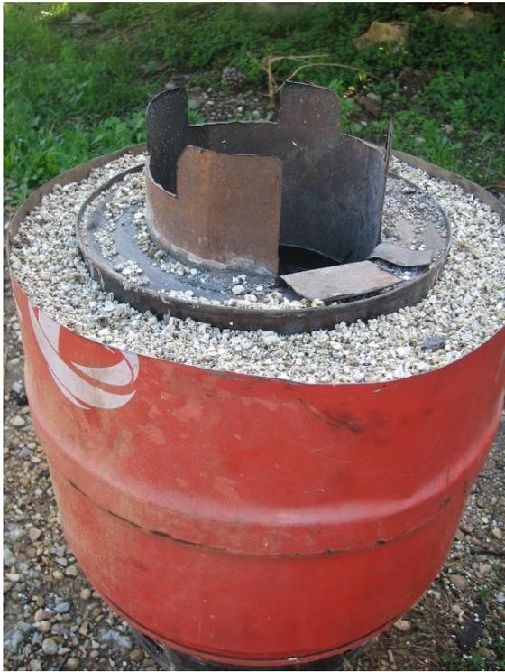
La partie entre le bidon d'huile de boîte à vitesse et le bidon d'huile de friture est rempli de vermiculite ou de cendre de bois pour l'isolation. Le tube inox central, de 180mm de diamètre est ouvert en haut pour le chargement du bois.
