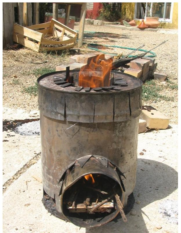
Voici un modèle plus puissant, l'Alter cuiseur E2, avec un chargement par le dessus et une jupe pour contraindre les flammes à suivre les contours de la casserole.
